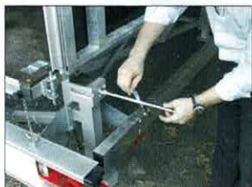
Kurbelstützen, zum einfachen Nivellieren des Bühnenbodens
