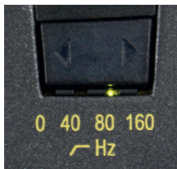
Illustration 3: Sélecteur de réduction des basses
